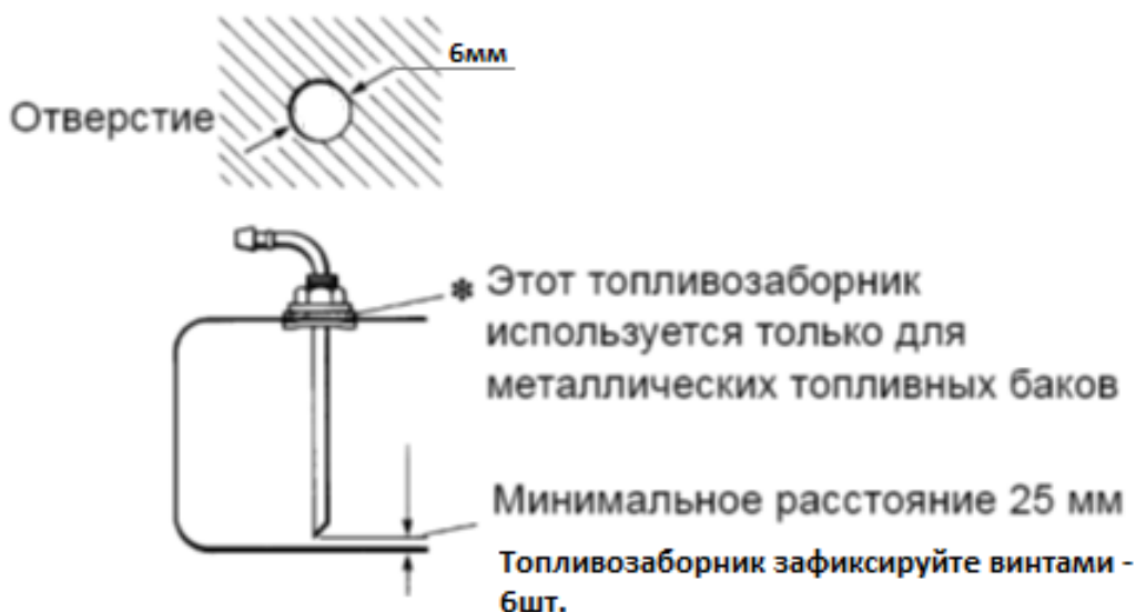
Рис.9 Пример монтажа грузового топливного заборника
